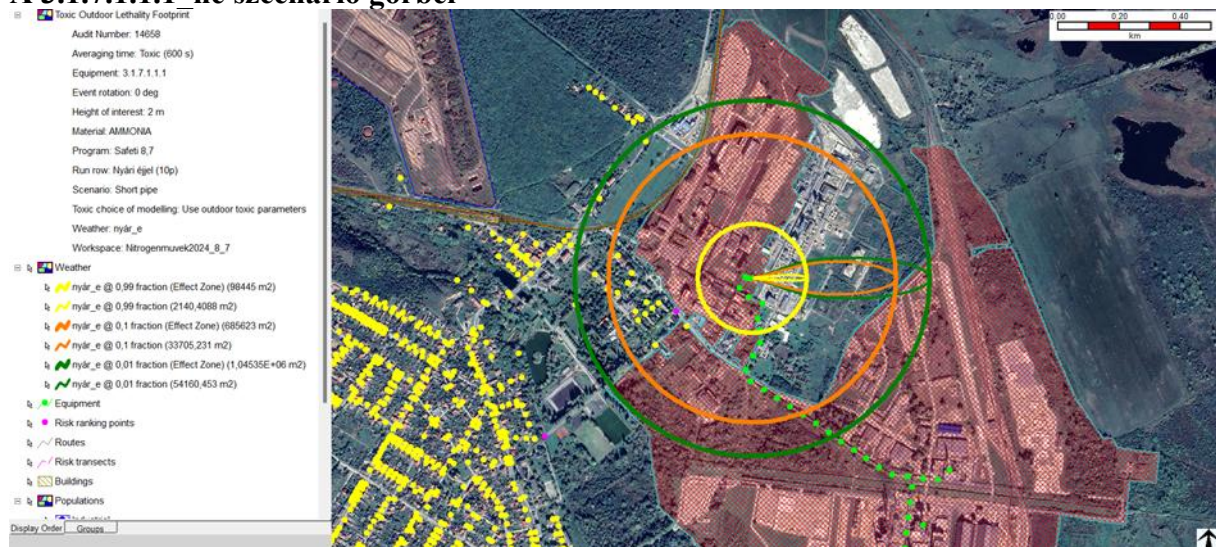
13. ábra: 3.1.7.1.1.1 ne baleseti esemény sor mérgezési hatásának bemutatása. A 99 (citrom), a 10 (narancs) és az 1%-os (zöld) halálozási valószínűségek tartományai egy lehetséges szélirány esetén (vékony vonal), és hatásövezete (vastag vonal) épületen kívüli tartózkodókra vonatkozóan.
