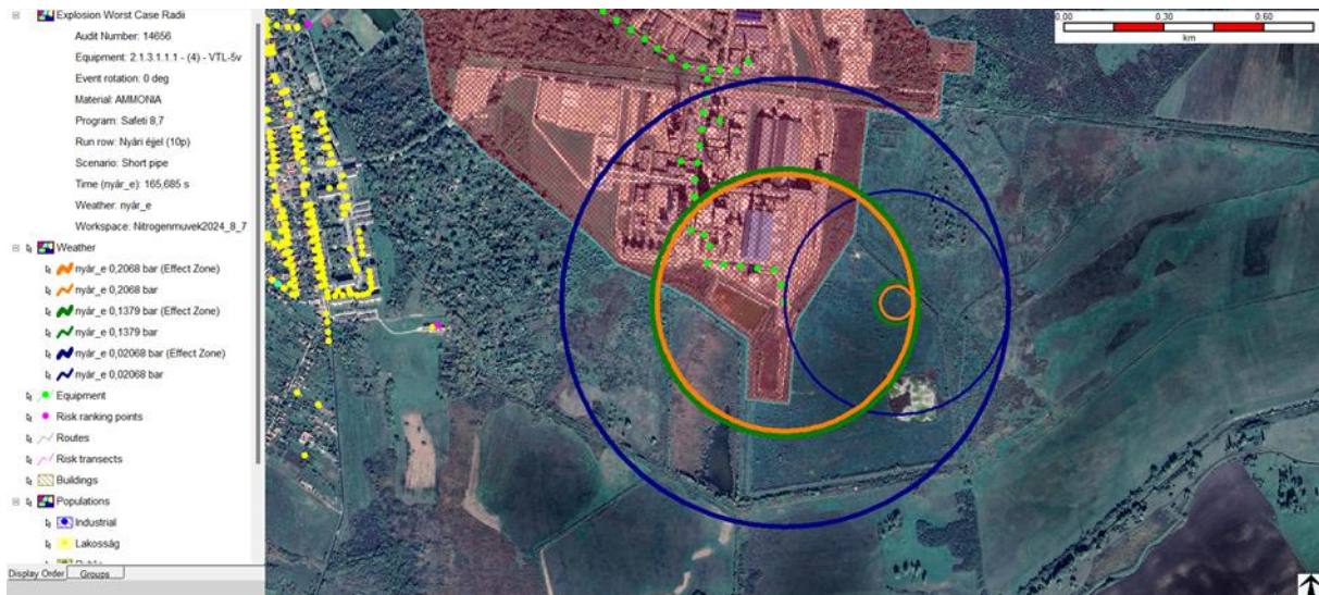
5. ábra: 2.1.3.1.1.1 - (4) - VTL-5v ne baleseti eseménysor túlnyomás hatásának bemutatása robbanás esetén. A 0,2068 bar (narancs), a 0,1379 bar (zöld) és az 0,02068 bar-os (kék) túlnyomás görbéi egy adott szélirány esetén (vékony vonal), és hatásövezete (vastag vonal).
