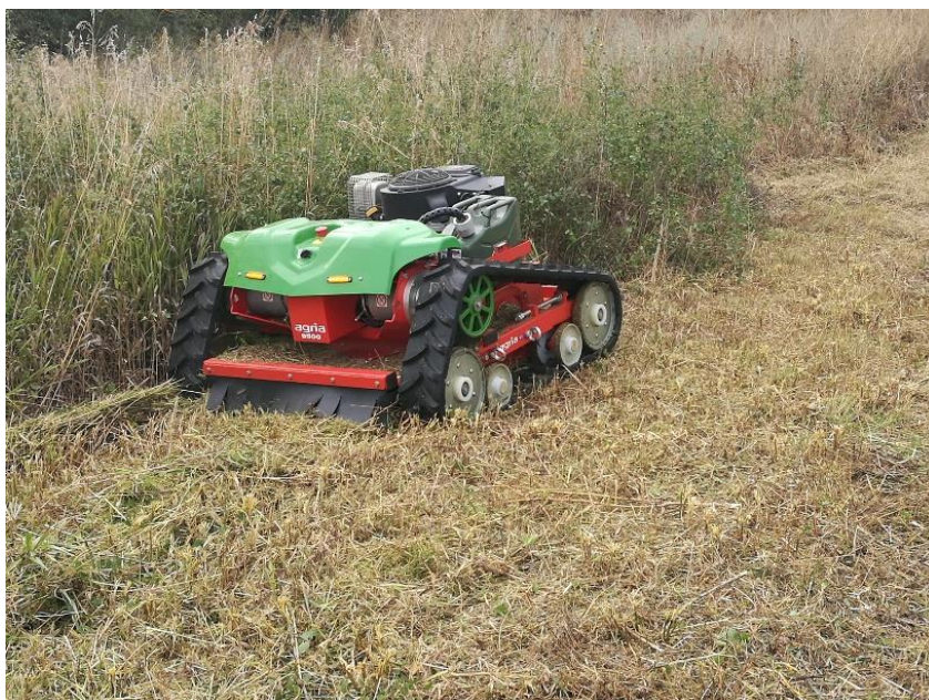
8. kép - munkában a távirányítású rézsűkasza SADE ároknál
